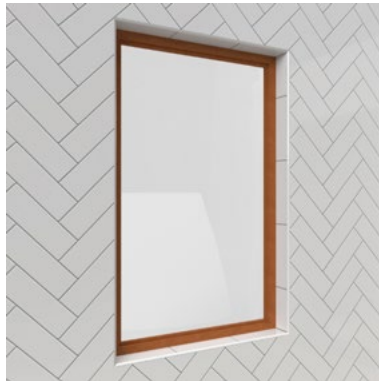
FIGUR 7. I figuren visas ett exempel på mönstersättning i form av fiskbensmönster med rak sättning i smygen.
