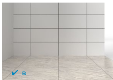
FIGUR 10 B. Fogar på golv och vägg är linjerade. Plattor på golv och vägg måste då vara modulanpassade.
