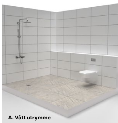
Figur 1 A-B. Normalt sätts keramiken vågrätt/lodrätt, om inget annat är avtalat. Till höger visas ett exempel på ett vått och torrt utrymme.
