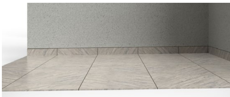
FIGUR 15 B. Sockelplattans övre kant följer golv/väggvinkeln.
